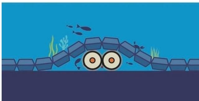
Figure 1.33 : Représentation d'une liaison sous-marine protégée par un matelas béton
