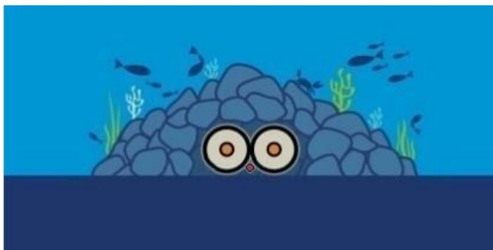
Figure 1.31 : Représentation d'une liaison sous-marine protégée par des enrochements
