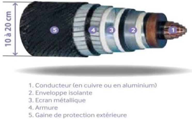
Figure 1.15 : Exemple d'un câble unipolaire à isolation papier imprégné (x2 pour une liaison à courant continu) – Source : RTE
