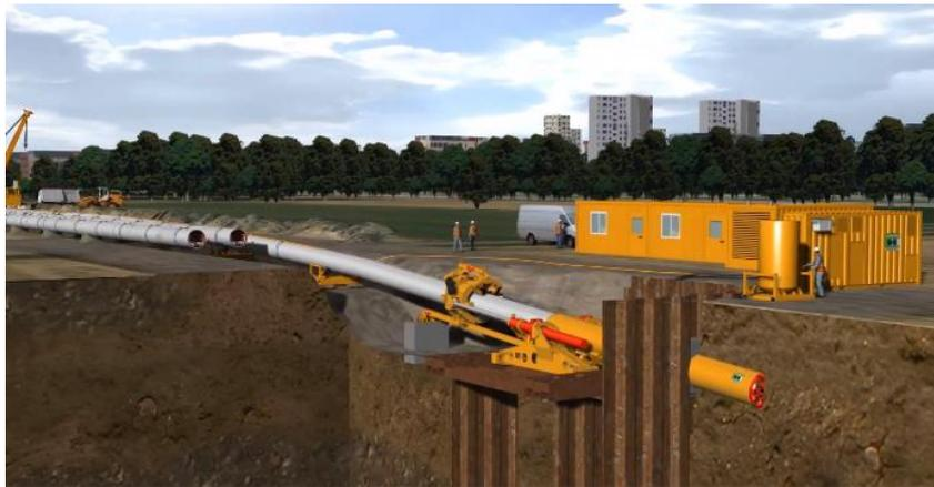
Figure 1.25 : Schéma de forage en technologie Direct-Pipe\* (Source : herrenknecht.com)
