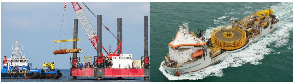
*Moyens nautiques potentiellement à mettre en œuvre pour la partie marine du direct pipe : (à gauche) exemple d'une barge jackup\* sur le projet Beatrice et (à droite) d'un navire câblé (Source : [Beatrice Offshore Wind Farm Landfall - Herrenknecht AG](#))*
