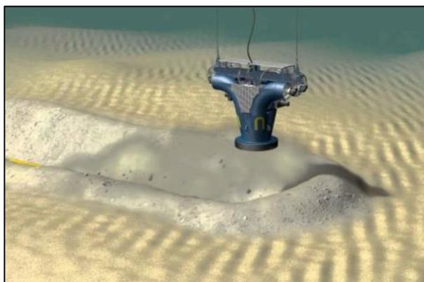
Figure 1.27 : illustration d'un Mass Flow Excavator
