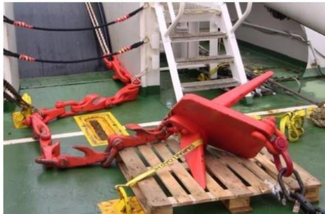
*Exemple de grappin pour l'éclaircissement des tracés des câbles*
